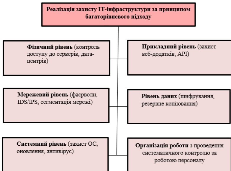
Рис.1. Реалізація захисту IT-інфраструктури за принципом багаторівневого підходу
